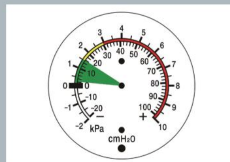
Manómetro de presión de las vías respiratorias para sistema de doble circuito
